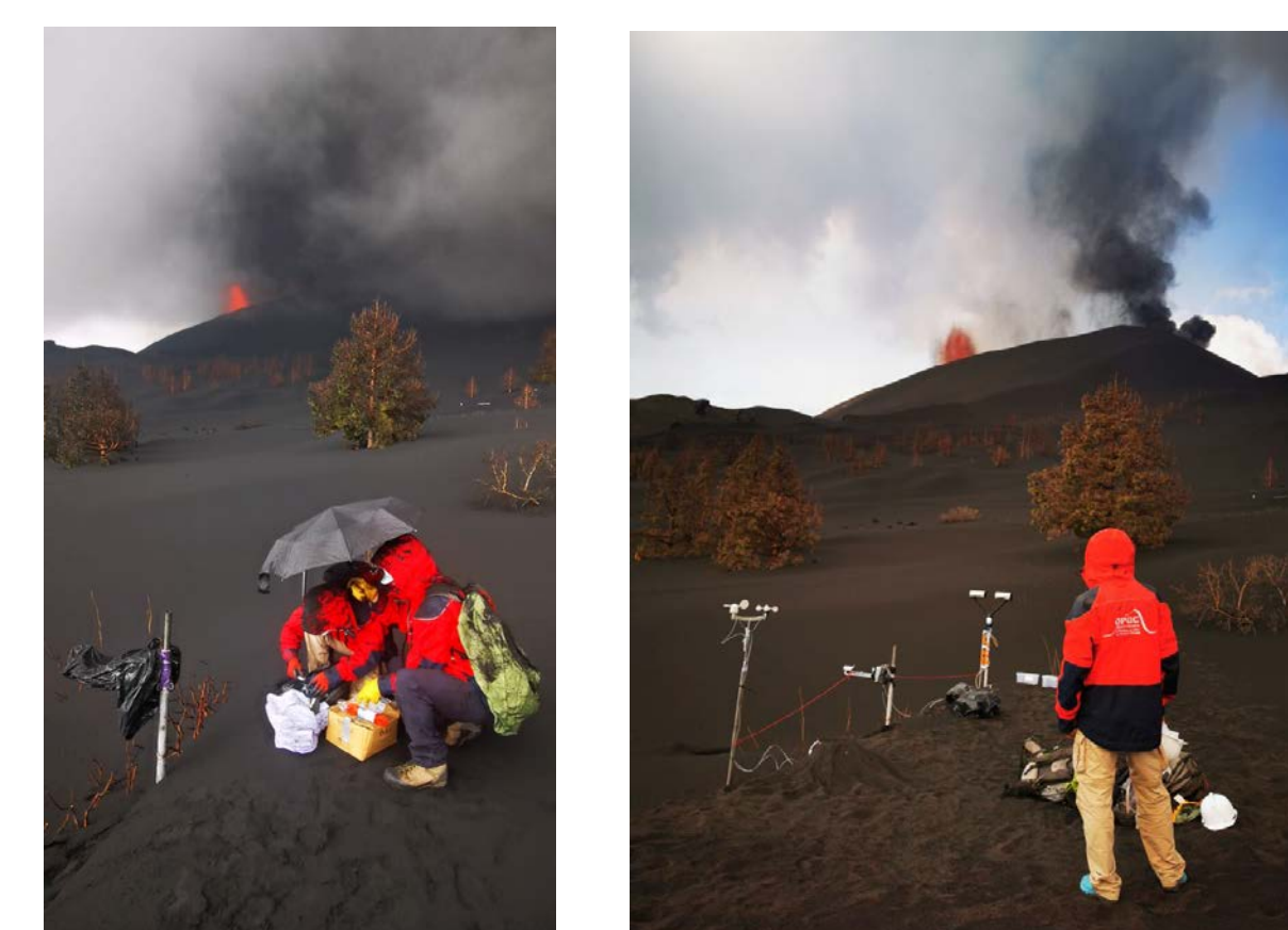
Installation de disdromètres pour mesurer les chutes de cendres sur le Cumbre Vieja (La Palma, îles Canaries) (octobre 2021)
