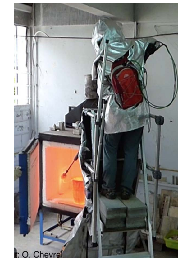
Test du viscosimètre à 1300 °C aux Arts du feu à La Réunion (2020)
